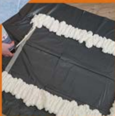
Spuit op een vuilniszak purschuim in een rechthoek. Laat dit minstens 2 uur drogen.
